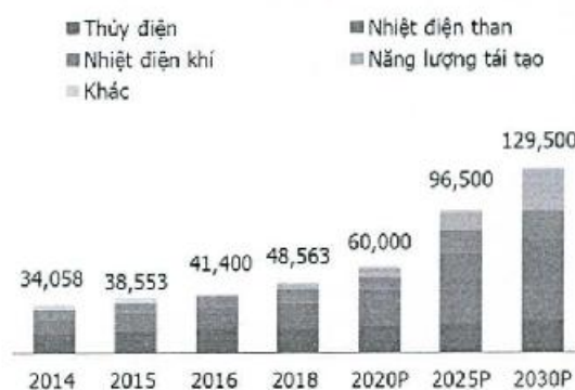
Hình 13: Công suất điện lắp đặt 2014-2030P (MW)
